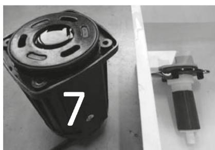
Placez la pompe en position verticale et remplissez-la avec un détartrant doux (comme du vinaigre ménager). Placez le rotor dans un récipient/bac plastique rempli du même produit détartrant et laissez agir durant 24 heures. Après 24 heures, rincez avec de l'eau et assemblez à nouveau la pompe.
