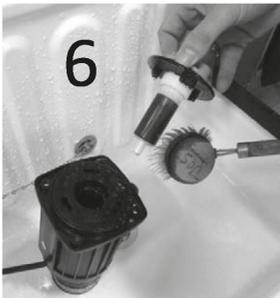
Rotor mit Wasser und Bürste reinigen
