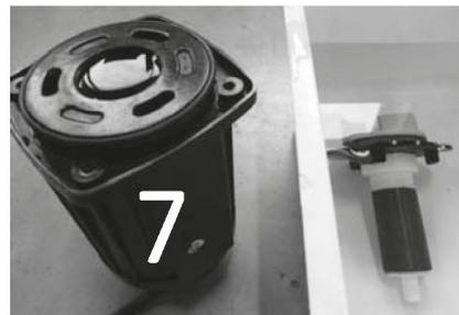
Das Pumpengehäuse aufrecht stellen und dieses mit milden Entkalker (Essigreiniger) füllen. Legen Sie den Rotor in einen Plastikbehälter mit Entkalker. Beides lassen Sie nun 24h stehen. Nach 24h mit Wasser abspülen und Pumpe wieder zusammenbauen.
