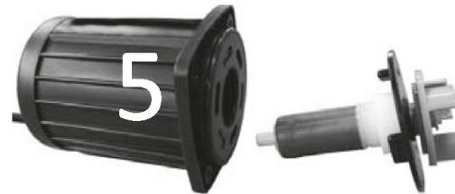
Rotor vom Pumpengehäuse entfernen
